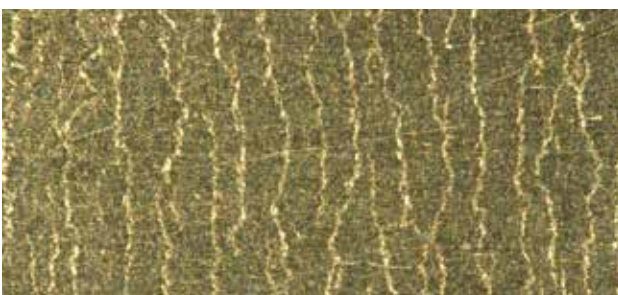
LINK PorEx® Oberflächen-Modifikation nach dem Biegeversuch Kein Ablättern der Modifikation, 100-fache Vergrößerung
